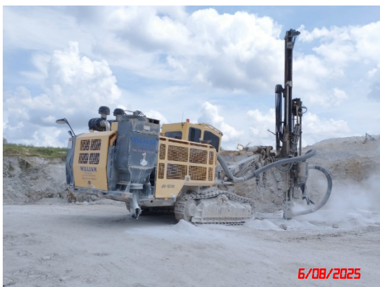
รูปที่ 11 รถเจาะรูระเบิดและรถเจาะย้อยหินใหญ่
